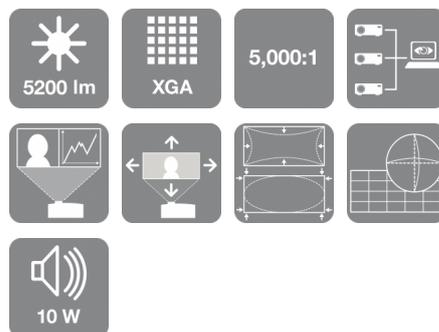
L'EB-4650 est le projecteur fixe XGA qui offre des images lumineuses et claires et des fonctionnalités haut de gamme faciles à utiliser. La technologie de projection 3LCD d'Epson et des sorties lumière blanche et couleur élevées de même intensité de 5 200 lumens, garantissent l'affichage de toutes vos présentations importantes avec des couleurs vives et réalistes et quelque soit l'environnement lumineux.
